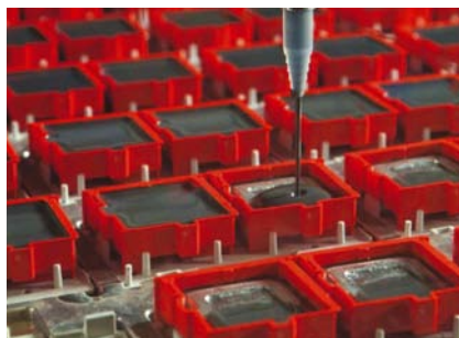
Obr. 1 Zalievanie varistora v module DEHNgard
